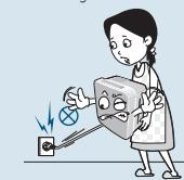
Gebrauch verboten, wenn das Kabel oder der Stecker beschädigt oder lose sind
