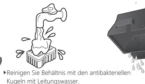
► Reinigen Sie Behältnis mit den antibakteriellen Kugeln mit Leitungswasser.
