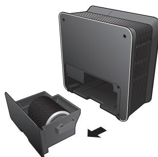
③ Entfernen Sie den Rotor mit Befeuchtungscheiben und die antibakteriellen NANO-SILBER Filter
