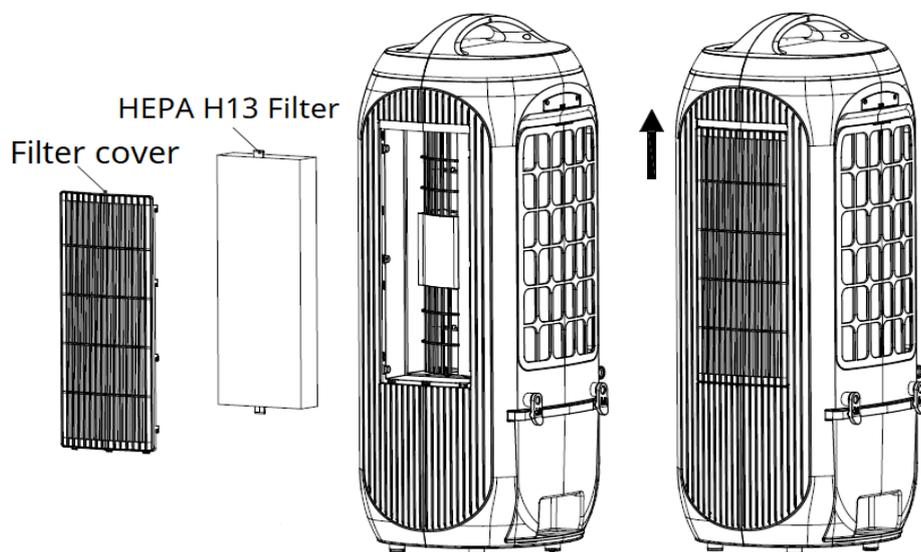
2. Faites glisser le couvercle du filtre vers le haut à l'arrière pour insérer le filtre d'évaporation.
