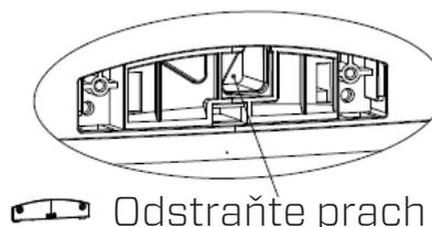
3. Čočku senzoru očistěte vatovým tamponem a vodou, jak ukazuje šipka. Poté čočku osušte čistým vatovým tamponem.
