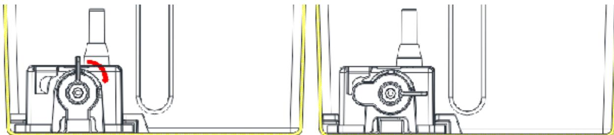
5. Saque la bomba de agua del soporte, como se observa en el esquema de la izquierda.
