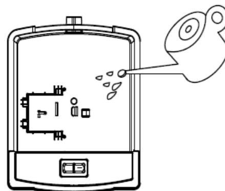
**Dėmesio!** Prietaisą pildykite tik šviežiu geriamuoju vandeniu. Vandens temperatūra gali būti ne aukštesnė kaip 40 °C.
