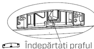
3. Curățați lentila senzorului cu un tampon de bumbac și apă, așa cum indică săgeata. Apoi, uscați lentila cu un tampon de bumbac curat.
