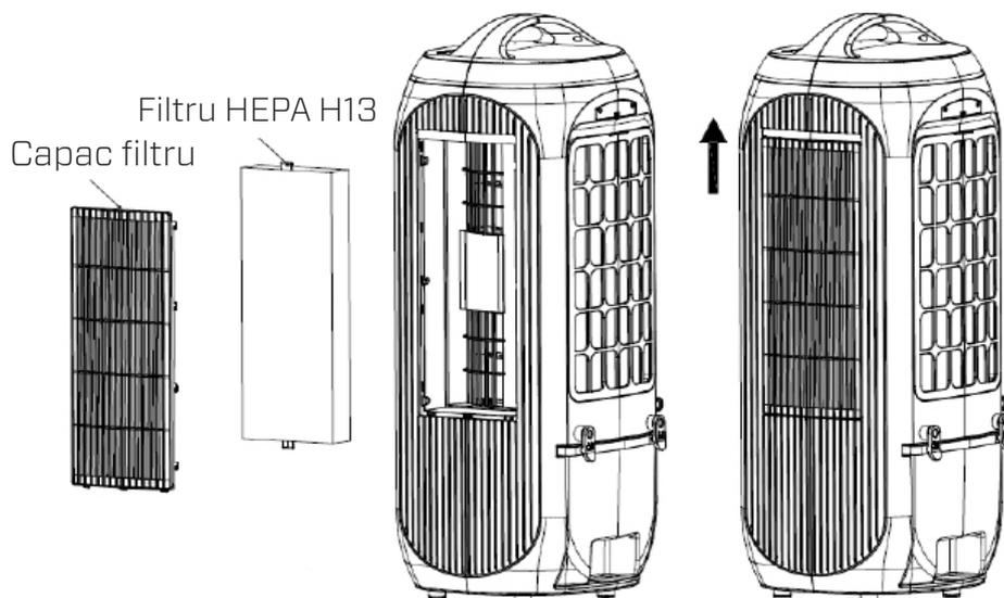
2. Glisați capacul filtrului în sus, pe partea din spate, pentru a introduce filtrul de evaporare.
