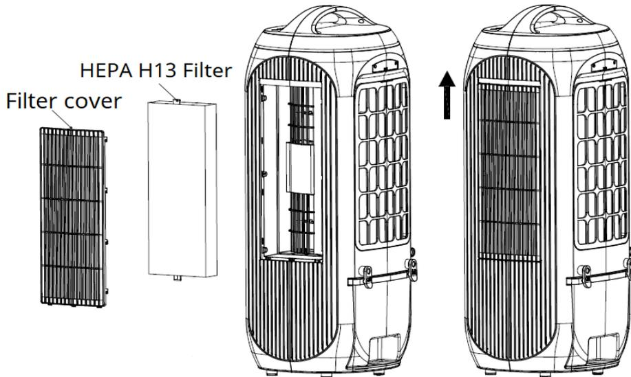
2. Schieben Sie die Filterabdeckung hinten nach oben, um den Verdunstungsfilter einzusetzen.
