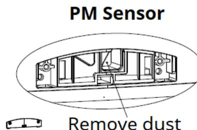
3. Maak de sensorlens schoon met een wattenstaafje en water zoals aangegeven door de pijl. Droog de lens vervolgens met een schoon wattenstaafje.
