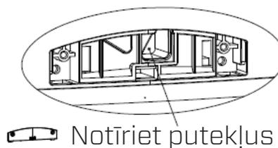
3. Notīriet sensora lēcu ar vates tamponu un ūdeni, kā norādīts ar bultiņu.
