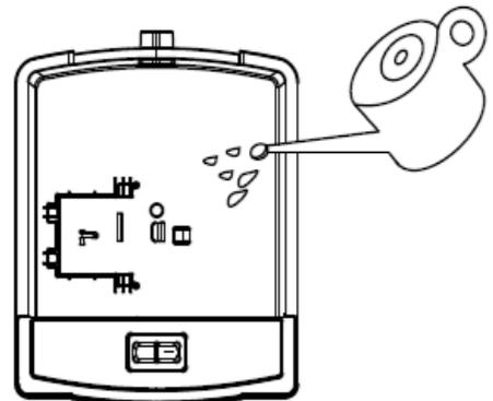
**Achtung:** Das Gerät nur mit frischem Trinkwasser befüllen. Die Wassertemperatur darf maximal 40°C betragen.
