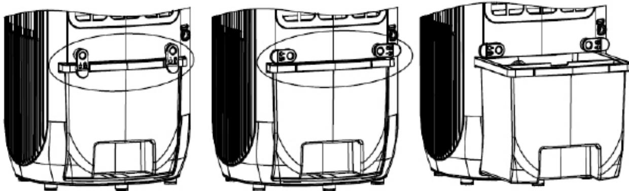
3. Trageți rezervorul de apă până la jumătate din aparat.
