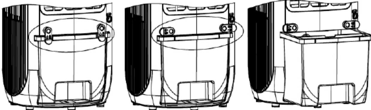
3. Umpleți rezervorul de apă cu o stropitoare, țineți cont de indicatorul de nivel maxim al apei, a se vedea pe partea frontală a aparatului.
